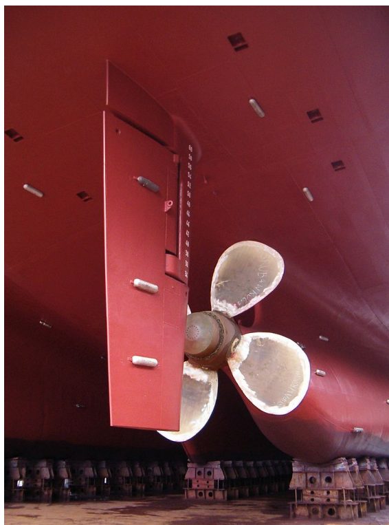
FIGURE 1 – Protection cathodique par anodes sacrificielles sur la coque et le safran d'un navire.
